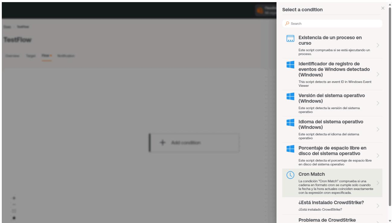
7. Afegeix els camps de comprovació de la condició (cada quant de temps es comprova) i la condició de programació "cron". Clica a **Guardar**, a la part inferior del panell. En l'exemple, es comprova la condició cada mitja hora i la condició "cron" és "tots els dilluns a les vuit del matí".
