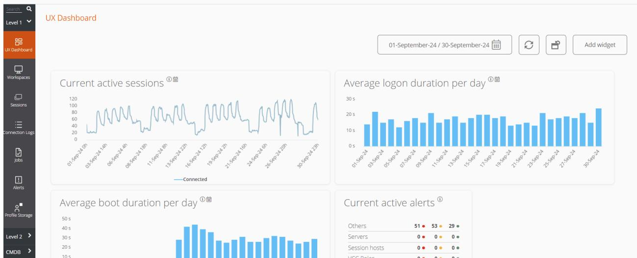
La vista és configurable i permet segmentar les dades per organització client, filtrar per dates i seleccionar els widgets que formaran part del dashboard. La configuració dels widgets inclosa en el dashboard, així com la seva posició i mida, persisteix entre sessions d'usuari, per la qual cosa només cal aplicar aquesta configuració una única vegada.
